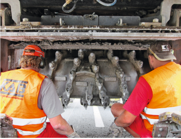
Fig. 2 Changement du tambour de la fraiseuse. Largeur utile : 2,2 m
