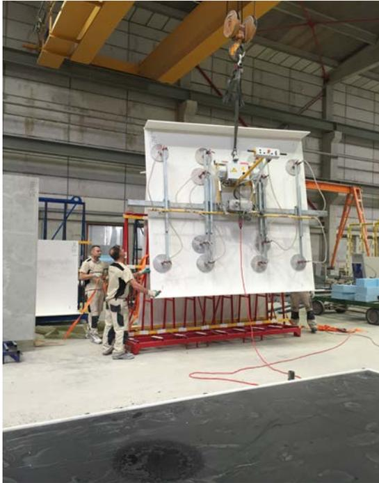
Geformte Fassadenbauteile mit Abmessungen bis 3m x 5m
