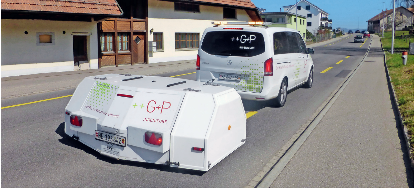
10 | Messsystem CPX der Grolimund + Partner AG zum Nachweis der akustischen Wirkung von Fahrbahnen. 10 | Système de mesure CPX de la société Grolimund + Partner AG pour prouver l'efficacité acoustique des chaussées.
