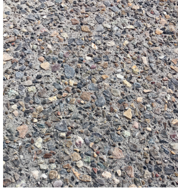
7 | Waschbeton GK 11 mm, Gesteine mittelländische Sedimente, Handeinbau. 7 | Béton lavé GK 11 mm, granulats extraits de sédiments du Plateau, pose manuelle.
