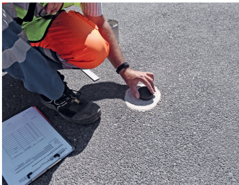
8 | Überprüfung der Rautiefe mittels Sandflächenmethode. 8 | Vérification de la profondeur de rugosité au moyen de la méthode de la tâche de sable.
