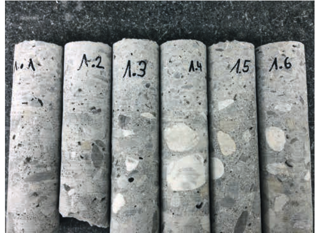
Carottes Ø 50mm extraites de la construction-test 1
