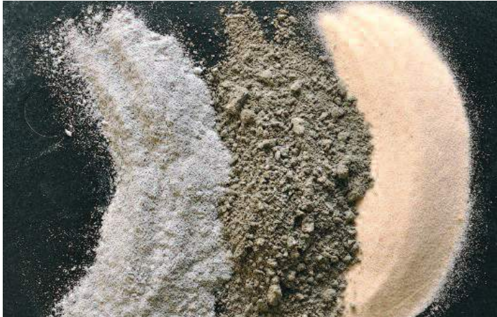
composants d'un BFUP: fumée de silice, ciment et sable de quartz
