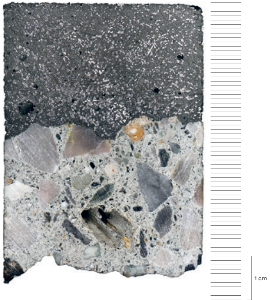
Fig. 1 Coupe microscopique d'une zone de contact entre un béton ordinaire et un BFUP. La différence entre les deux matériaux est bien visible (dimension des granulats, armature de fibres, compacité)
