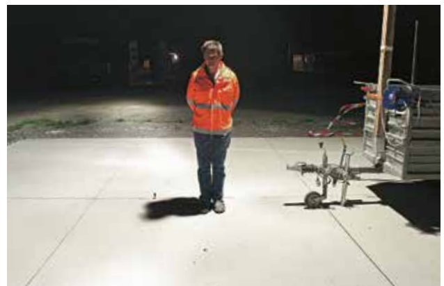
Illustration 16: Visibilité d'une personne-test (à gauche: asphalte coulé; à droite: revêtement en béton)
