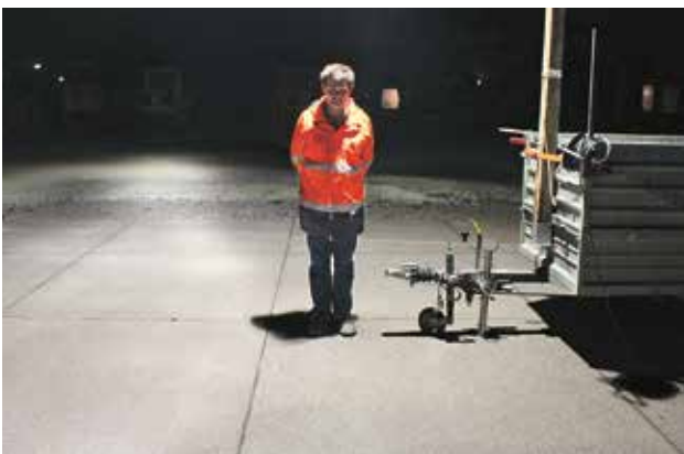
Illustration 16: Visibilité d'une personne-test (à gauche: asphalte coulé; à droite: revêtement en béton)
