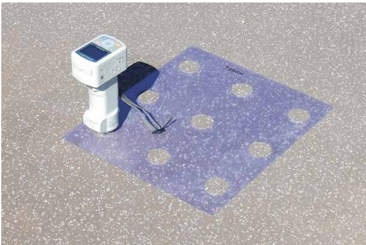
Illustration 10: Disposition des mesures pour le calcul du taux de réflexion
