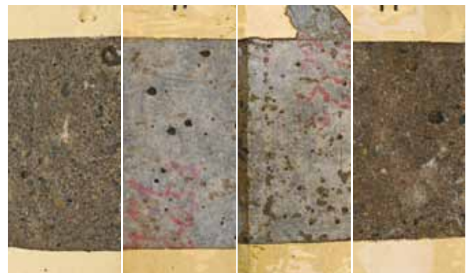
Abbildung 17: Schallflächen nach 90 Tagen Auslagerung in verschiedenen ARA (gut nachbehandelter Prüfkörper des Betons B-OPC-1, von links nach rechts: ARA Region Luzern, ARA Surental, ARA Lyss, ARA Wald, zweite Auslagerung)
