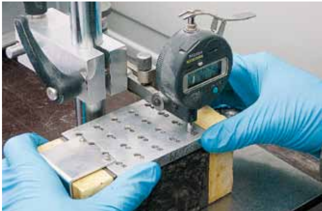
Abbildung 14: Nullmessung mittels kalibrierter Tiefenlehre
