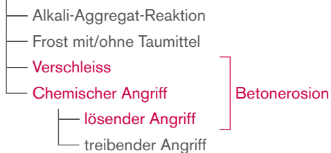
Abbildung 5: Betonkorrosion und Betonerosion
