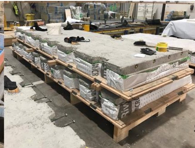
Betonschicht im Werk Lagerung für Schwindverformungen
