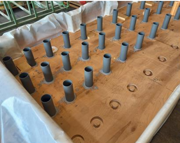
Buche-Furnierschichtholzplatte Stahlrohre als Schubverbinder
