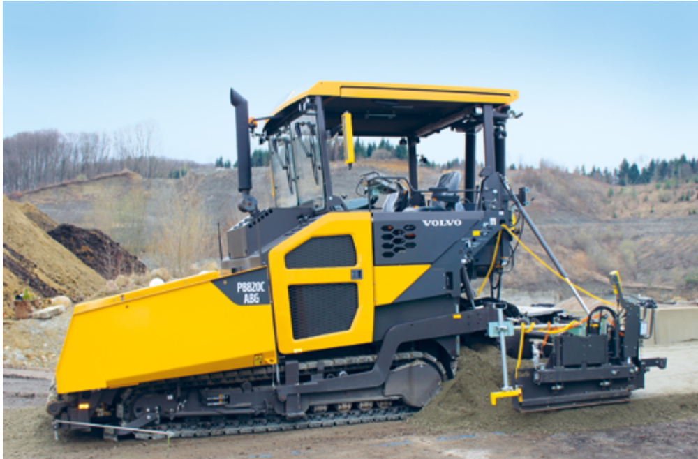
Finisseur sur chenilles Volvo avec table de lissage à double équipement dameur
