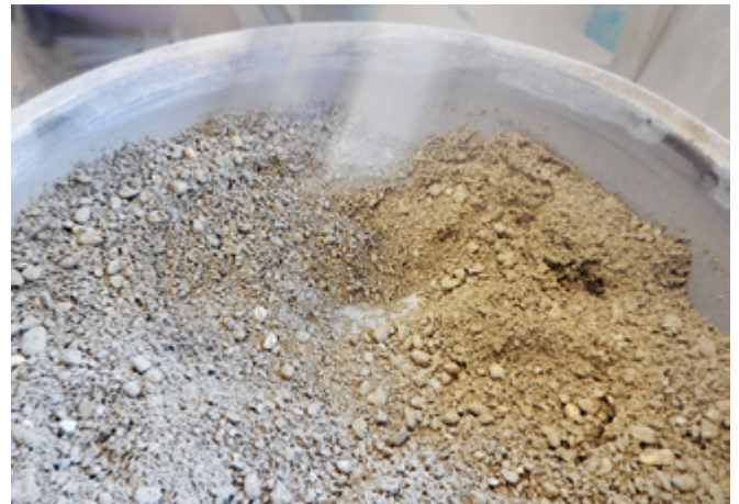
Mélange de béton à consistance de terre humide étudié en laboratoire
