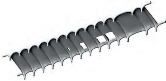
Fig. 3 Flächengeometrisches Computermodell der Gewölbstruktur inkl. Einlagen und Aussparungen. Surface geometric computer model of the vaulted structure including inserts and recesses.
