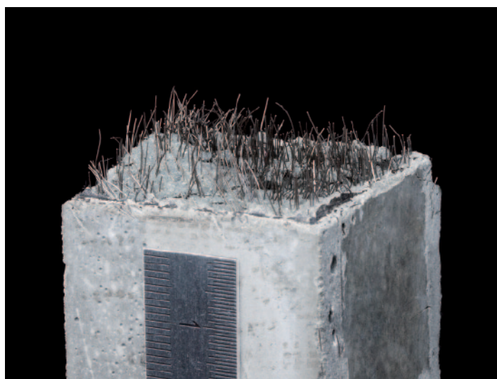
Afin d'accroître la ductilité du BFUP, on ajoute des fibres métalliques ou synthétiques au mélange.
