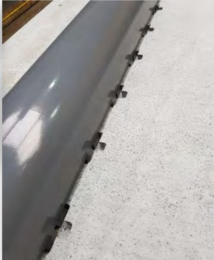
Verzahnung Carbonhalbträger mit CPC-Betonplatte
