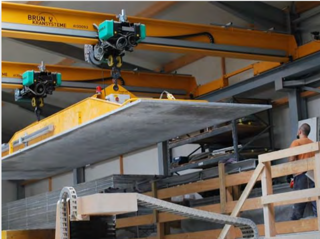
Rohplatte 10m x 2.4m, 40mm wird mit einem Saugheber vom Plattenstapel genommen
