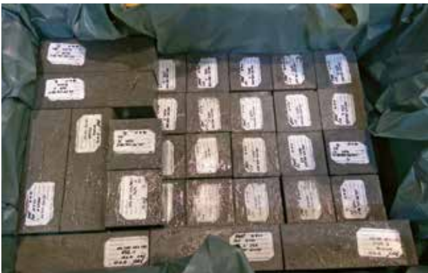
Abbildung 18: Die Betonprobekörper vor der Lieferung an das Betonlabor © AFTTG
