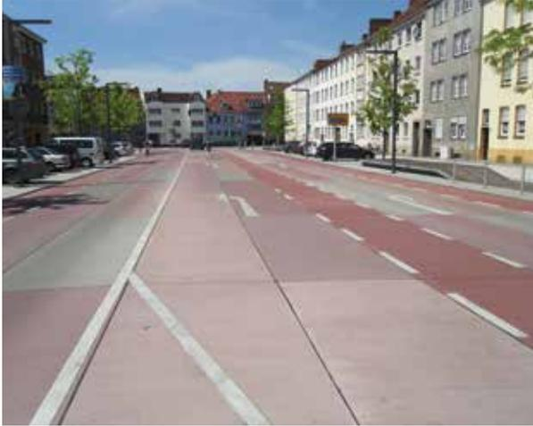
Fig. 9 : Délimitations en surface par la coloration et les joints
