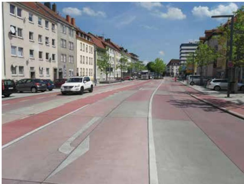
Fig. 14 : Teinté dans la masse, le revêtement en béton conserve sa coloration malgré les incessants passages de véhicules
