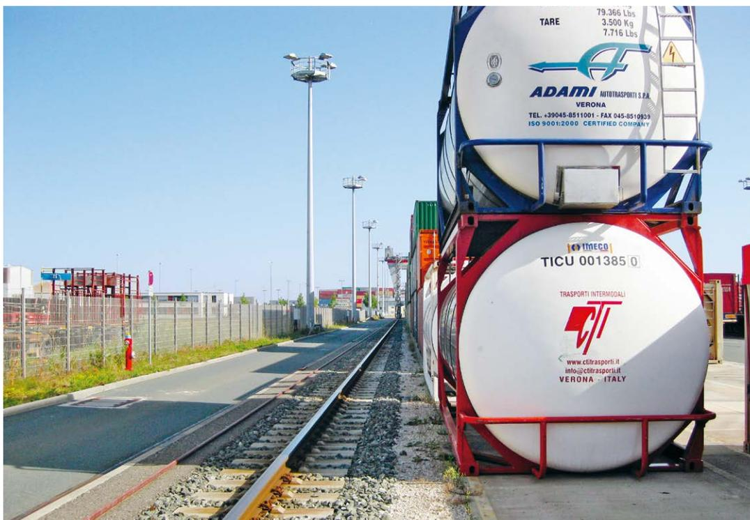
Emplacement de stockage peu favorable sur le bord de dalle libre et avec les pieds des conteneurs au niveau des joints.
