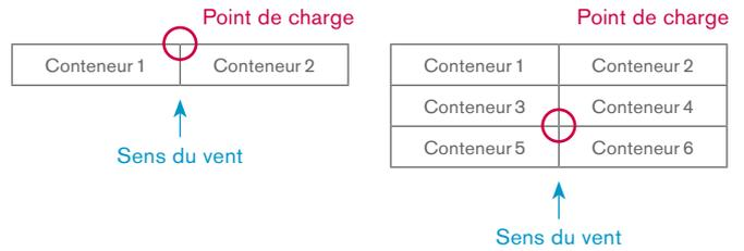
Schémas d'un ordonnancement des conteneurs en une ou plusieurs rangées avec points de charge importants pour le dimensionnement
