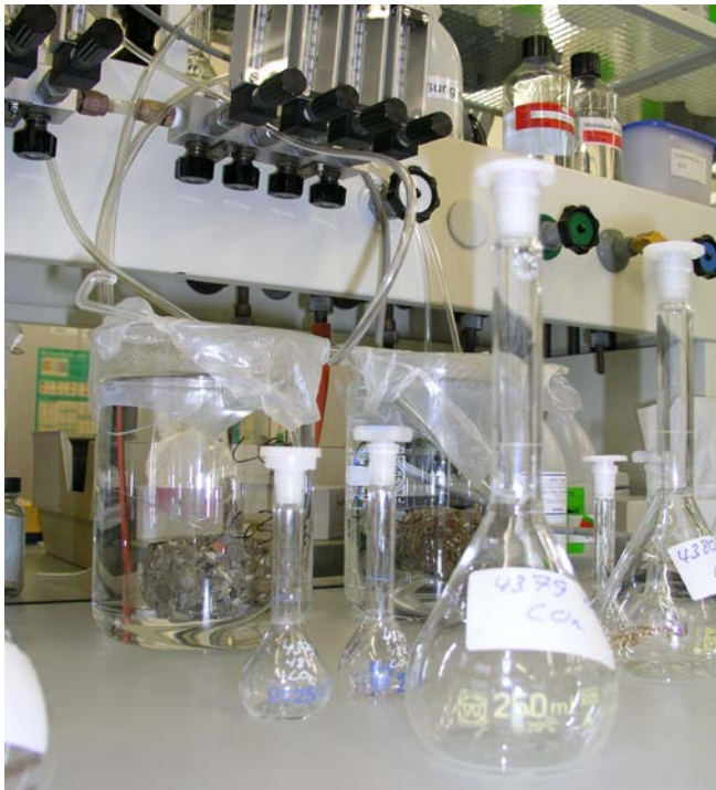
Eluatuntersuchungen an Recyclingbetonproben
