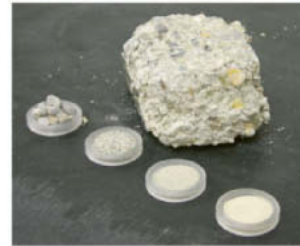
Elektrodynamische Fragmentierung: Zerlegen des Betons in seine Einzelbestandteile (Gesteinskörnung und Zementstein)
