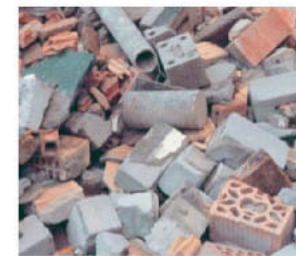
Mischabbruch Gemisch aus rückgebauten Massivbauteilen wie Betonabbruch, Backstein-, Kalkstein- und Natursteinmauerwerk
