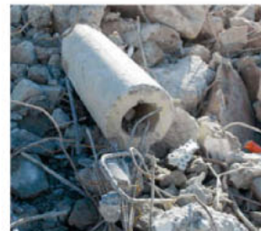
Betonabbruch Rückgebaute bewehrte/unbewehrte Betonkonstruktionen und -beläge
